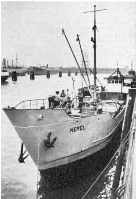
An dem überhängenden hochgezogenen Meierstegen des Motorschiffs vor uns prangte der Name „**Memel**“. 240 Tonnen ist die „Memel“ groß. Sie ist recht schmal gebaut; die Breite beträgt nur 5,30 Meter bei einer Länge von 36 Metern. Im Jahre 1951 wurde sie zum Motorschiff umgebaut.
